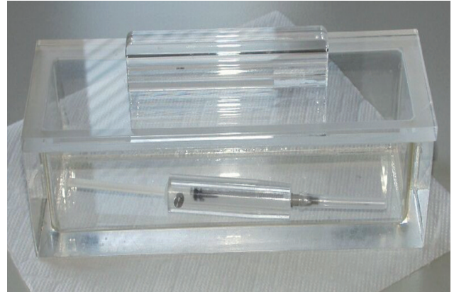
Abbildung 5: Plexiglas-Lager- und Transportbehälter
