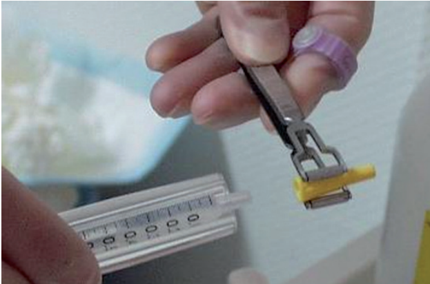
Abbildung 4: Spezialpinzette für Stopfen
