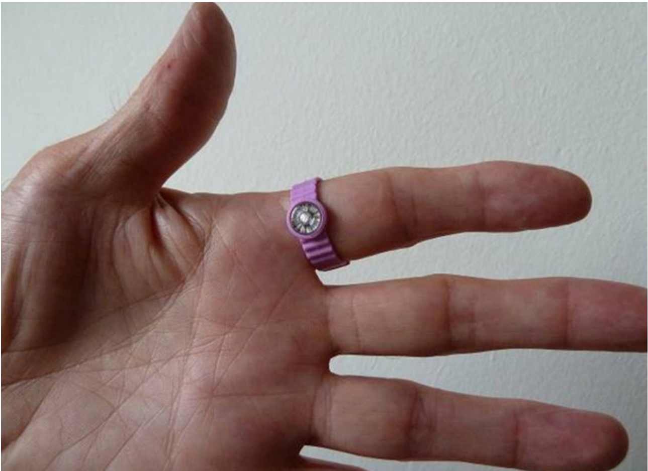
Abbildung 12: Empfohlener Trageort des amtlichen Beta-/Photonen-Fingerringdosimeters ist der Zeigefinger der nichtdominanten Hand (linke Hand bei Rechtshändern).
