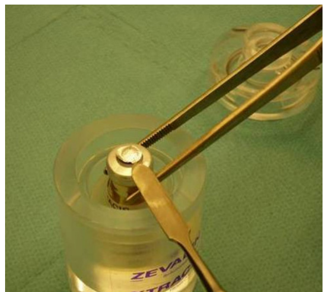
Abbildung 3b: Hilfsmittel zum Öffnen des Vials, z. B. ein Spatel, verringern die Exposition deutlich.
